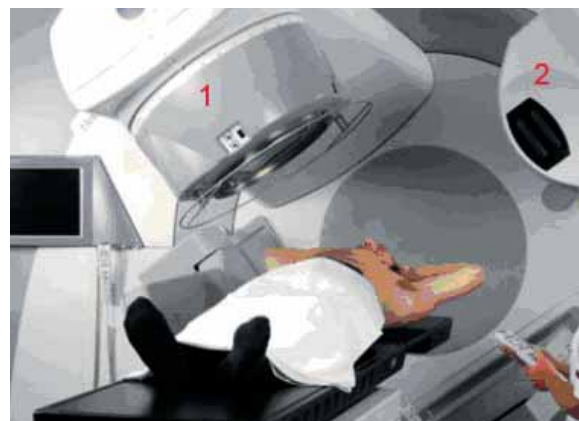
Accélérateur linéaire avec système d'imagerie embarqué 1. tête isocentrique. 2. source de rayons x (imagerie)
