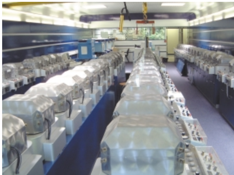
Illustration 1. Salle des compteurs alpha et bêta à bas bruit de fond et des chaînes de spectrométrie gamma de l'IRSN - site du Vésinet.
