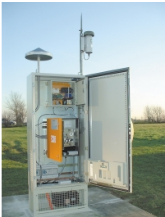
Illustration 5. Balise de mesure automatique des aérosols équipée d'une sonde Téléray
